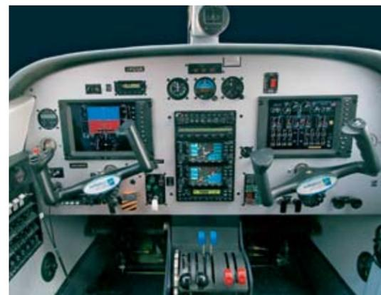
**STANDARD:** Die Flugzeuge der P68-Serie werden alle mit einem Glascockpit ausgeliefert. Lieferant ist die Firma Sagem Avionics. Der Nav/Com-Bereich des Multifunktionsdisplays wird von einem Garmin GNS 430/530 zum Leben erweckt.
