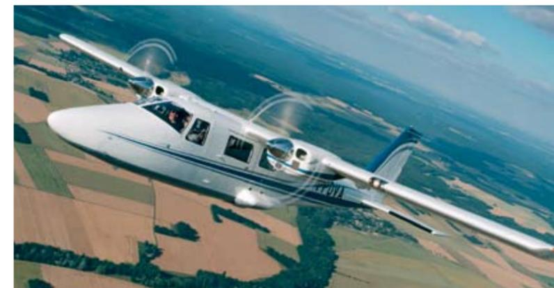
arbeiteten Version, wieder angeboten. Sie firmiert unter dem Namen A-Viator und der Typbezeichnung AP68TP-600. Als Antrieb dienen zwei Rolls-Royce-Turbinen 250-B17C. Die Metallpropeller sind dreiblättrig. In der Commuter-Version verfügt die Kabine über zehn Sitzplätze. Die Nutzlast liegt bei 870 kg.
