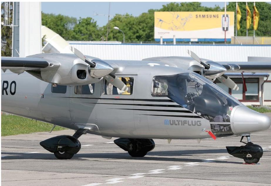
Die P68 Observer ist eine für Überwachungsaufgaben modifizierte Version. Das weitgehend verglaste Cockpit erlaubt Sichtverhältnisse wie aus einem Hubschrauber. Für private Anwendungen ist diese Variante jedoch uninteressant.
