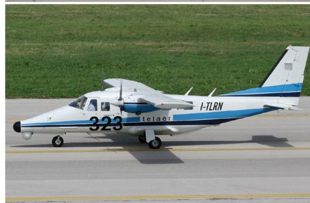
Die Weiterentwicklungen der P68. Oben: P68 „Spartacus“ mit zwei 330 PS Allison-Turbinen und festem Fahrwerk. Unten: AP68TP-600 „Viator“ ebenfalls mit Allison-Turbinen, aber mit verlängertem Rumpf und Einziehfahrwerk. Bild unten: Vulcanair
